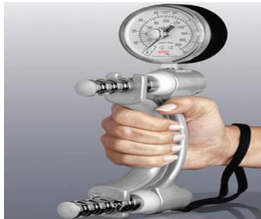
Εικ. 4. Δυναμόμετρο χειρός για τη μέτρηση της δύναμης σύσφιγξης γροθιάς. (Πηγή: Admin (2015) [95]).
